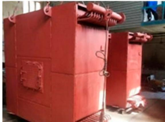
Экономайзер БВЭС-I-2 выполнен в две колонки и разделён между собой стальной перегородкой. Последовательно газы омывают одну, затем вторую колонку. Каждая колонка разделена на две секции, расположенные друг от друга на расстоянии 450мм, что даёт возможность периодически проводить осмотр и обдувку пакета труб.
