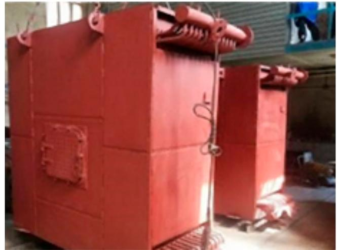
Экономайзер ЭПС-7,5 выполнен в две колонки и разделён между собой стальной перегородкой. Последовательно газы омывают одну, затем вторую колонку. Каждая колонка разделена на две секции, расположенные друг от друга на расстоянии 450мм, что даёт возможность периодически проводить осмотр и обдувку пакета труб.
