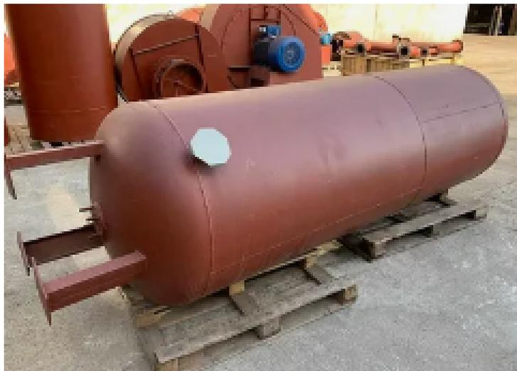
В процессе фильтрования жёсткой воды рабочая обменная способность натрий-катионита истощается и в дальнейшем происходит процесс регенерации натрий-катионита с вытеснением из него ранее поглощённых ионов кальция и магния 6%-ым раствором поваренной соли NaCl.
