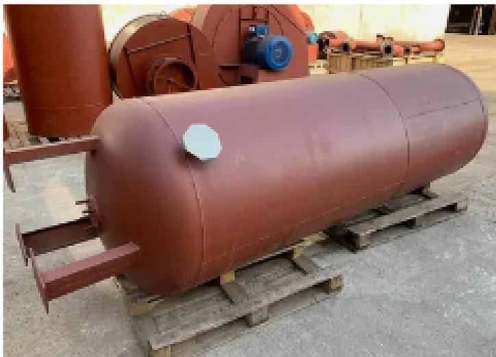
Противоточный метод ионирования заключается в пропуске через ионит регенерационного раствора и обрабатываемой воды в противоположных направлениях. При этом обрабатываемая вода перед выходом из фильтра соприкасается с хорошо отрегенированными слоями ионита, что обеспечивает более глубокий ионный обмен и повышенное качество умягченной воды.
