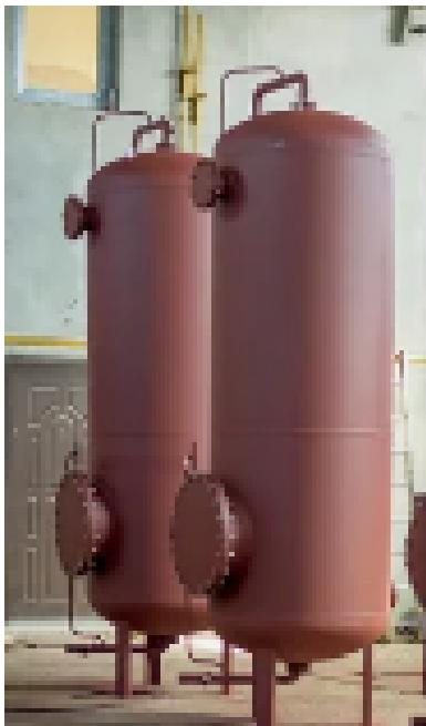
Противоточный метод ионирования заключается в пропуске через ионит регенерационного раствора и обрабатываемой воды в противоположных направлениях. При этом обрабатываемая вода перед выходом из фильтра соприкасается с хорошо отрегенерированными слоями ионита, что обеспечивает более глубокий ионный обмен и повышенное качество умягчённой воды.
