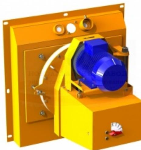
В зависимости от конструкции воздушного корпуса жидкотопливные горелки обозначаются РМГ-1м-01 или РМГ-1м-02 (в соответствии с рисунком ниже). Они состоят из жидкотопливной форсунки Р-100м и воздушного корпуса. Служат для сжигания мазута, нефти, легкого жидкого топлива (дизельного, печного бытового) в оборудованных дымососом топках [паровых котлов типа Е, ДЕ](#) и других типах котлоагрегатов соответствующей тепловой мощности.
