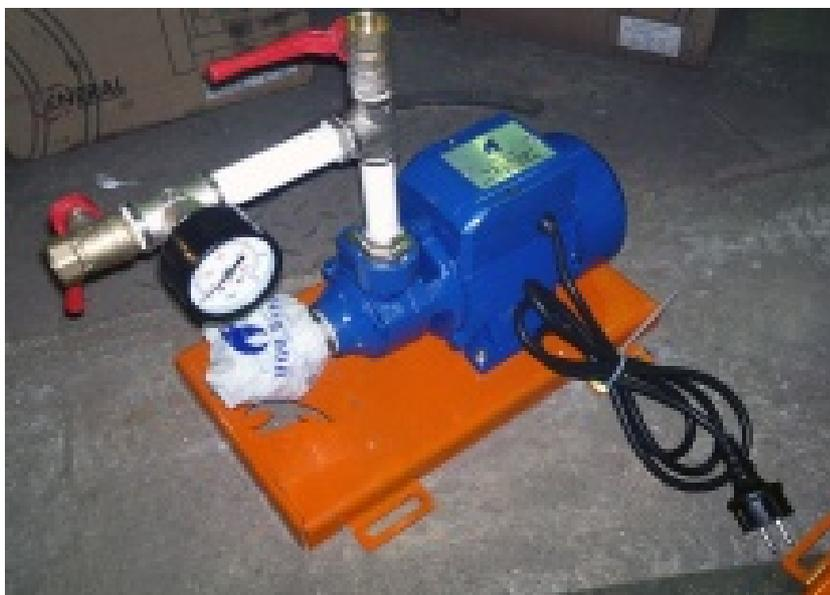
Система подачи легкого жидкого топлива предназначена для перекачивания дизельного топлива, антифриза, жидких масел и других жидкостей не содержащих абразивных частиц и не корродирующих с материалами насоса из бочек, емкостей глубиной не более 8м (после установки обратного клапана на конце всасывающего трубопровода, предварительной заливки насоса и всасывающего трубопровода).
