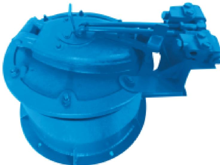
В **устройстве топочном** 19-01-06-000-1 мазут (сырая нефть) поступает по нижней трубе и движется к устью форсунки, а пар подводится по верхней трубе и устремляется к паровой щели форсунки при давлении пара 0,4МПа. Паровая струя подхватывает вытекающий из устья форсунки мазут (сырую нефть) и распыливает его в топке за пределами форсунки.
