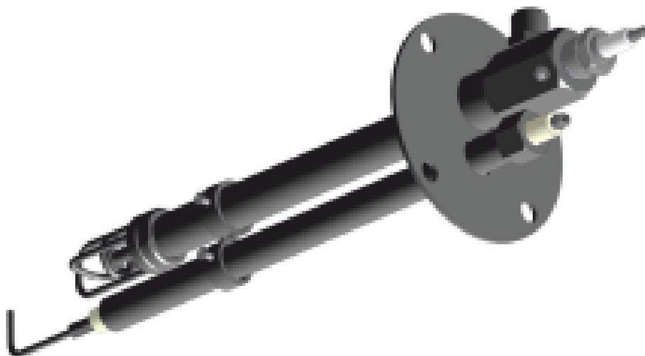
Запально-защитное устройство ЗЗУ-350 предназначено для розжига горелок, работающих на жидком или газообразном топливе, а также для контроля наличия пламени в топках котлоагрегатов. ЗЗУ-350 включается в общую схему автоматики котла либо работает самостоятельно.
