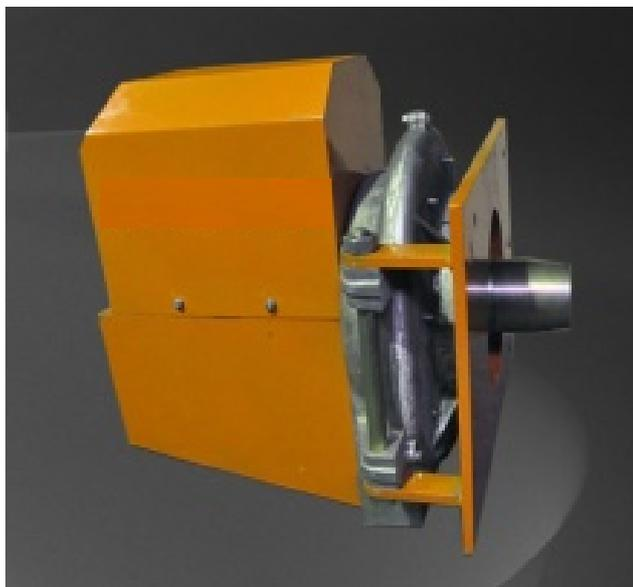
Жидкотопливные ротационные форсунки **Р-400, Р-700** являются составной частью горелок типа РГМГ мощностью 5,2 и 8,15 МВт и предназначены для сжигания мазута, нефти, легкого жидкого топлива (дизельного, печного бытового) в топках паровых и водогрейных котлов соответствующей мощности.
