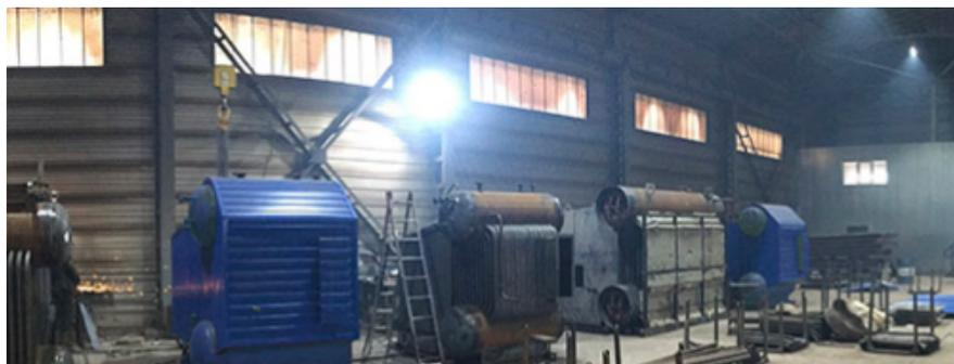
Котлы серии КЕ предназначены для выработки насыщенного или перегретого пара, используемого на нужды отопления объектов промышленного и бытового назначения, а также для технологических целей предприятий различных отраслей.
