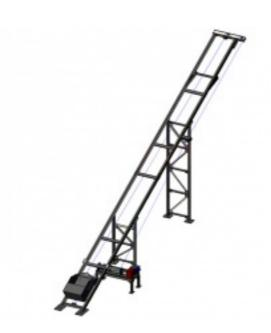
Скиповый подъемник (аналог БиКЗ) предназначен для подачи сыпучих материалов (каменный уголь, шлак, песок, гравий, щебень).
