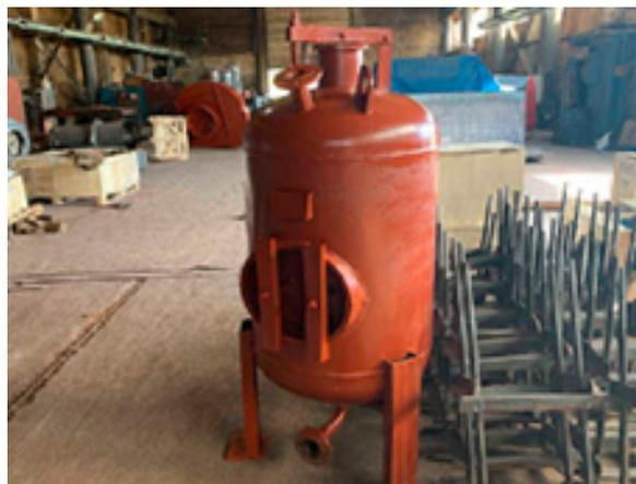
Через загрузочное устройство на верхнем днище поваренная соль загружается в солерастворитель С-1,0-1,0, в количестве, необходимом для регенерации одного фильтра. Под давлением до 0,6 МПа в солерастворитель подается вода. При прохождении её через реагент образуется раствор, осветление которого происходит при фильтровании через слой фильтрующего материала, находящегося в солерастворителе.
