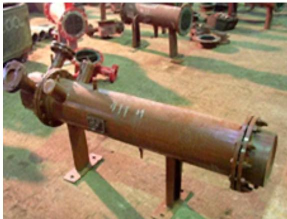
В теплообменнике Q=20-40 т/ч нагрев воды производится за счёт использования тепла продувочной воды паровых котлов.
