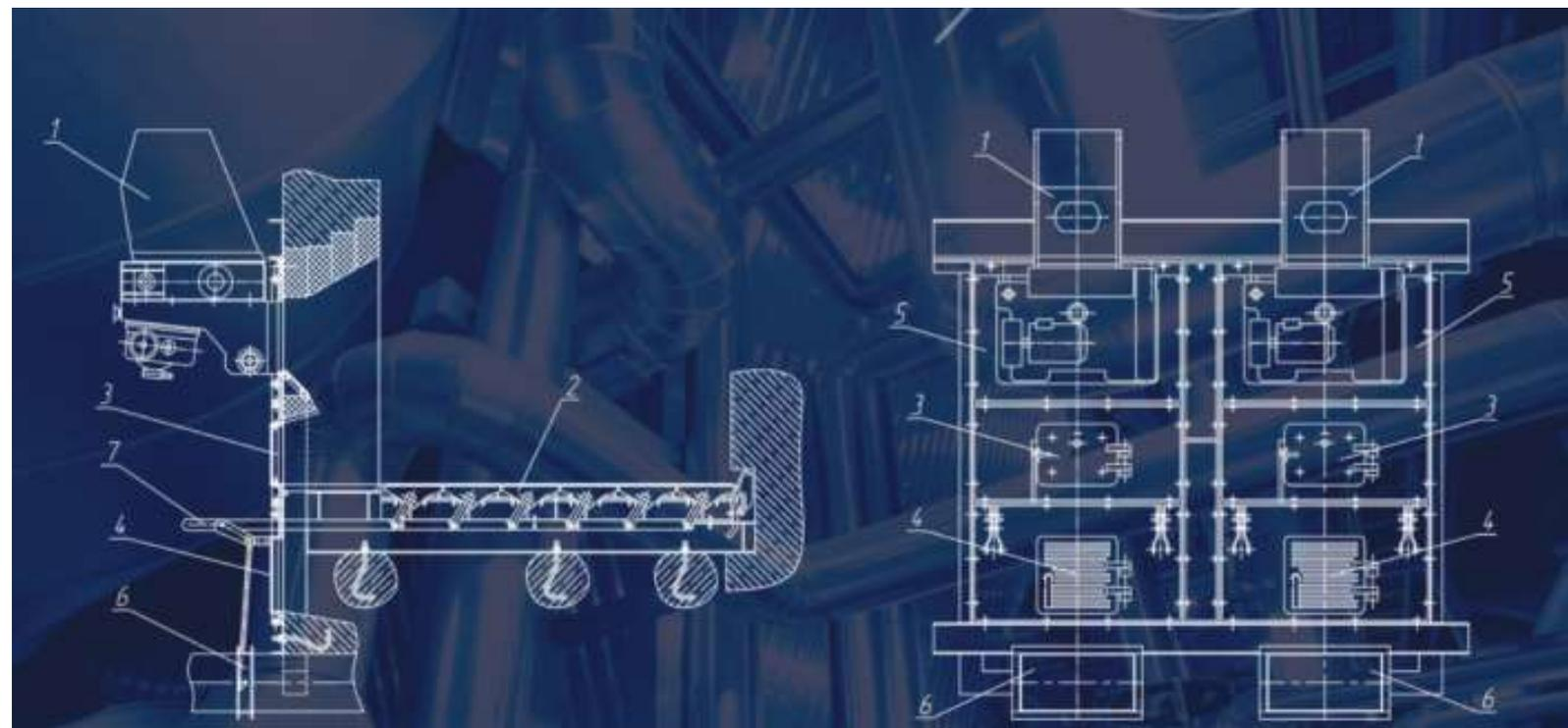
Рис.1. Топка серии РПК. 1. Забрасыватель топлива; 2. Решетка с поворотными колосниками; 3. Дверка топочная; 4. Дверка зольниковая; 5. Плита забрасывателя; 6. Воздушная заслонка; 7. Рычаг опрокидывания колосников и открытия воздушной заслонкой.
