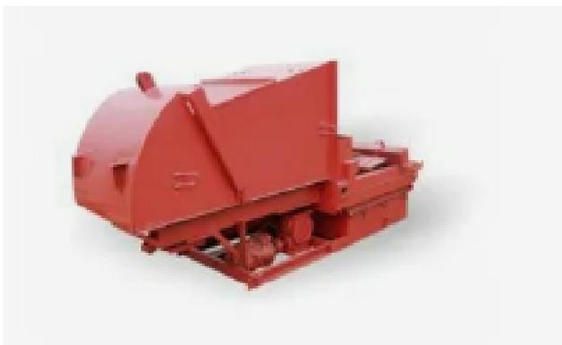
Топка ПТЛ-РПК-2-1,8/2,135 с питателями топлива ленточными и с решёткой с поворотными колосниками предназначена для сжигания каменных и бурых углей и используется в паровых котлах паропроизводительностью от 2,5 до 10 т/ч и в промышленных печах.
