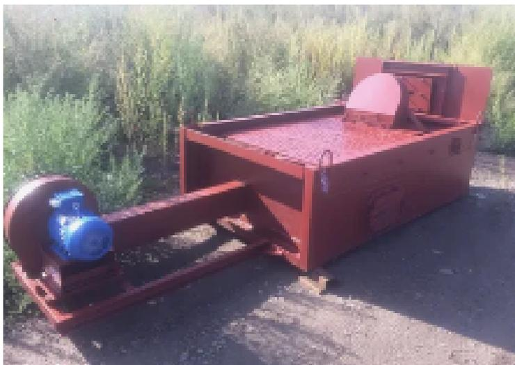
Топка ПТЛ-РПК-2-2,66/3,66 с питателями топлива ленточными и с решёткой с поворотными колосниками предназначена для сжигания каменных и бурых углей и используется в паровых котлах паропроизводительностью от 2,5 до 10,0 т/ч и в промышленных печах.
