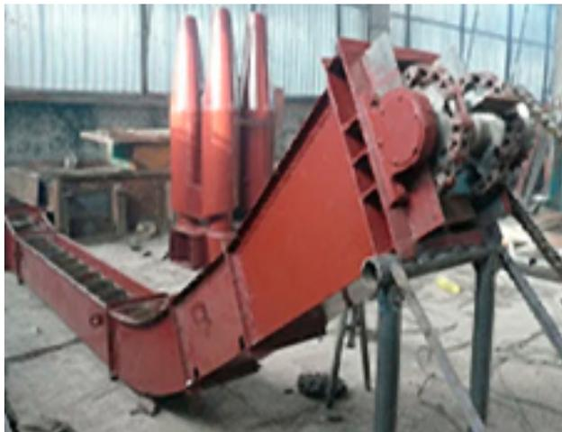
**Транспортер скребковый ТС-2-30** нашего производства предназначен для удаления шлака из-под топок паровых и водогрейных котлов малой мощности и подачи угля в котельную. Транспортер ТС-2-30 состоит из привода, натяжной, приводной, прямолинейных секций, поворотных секций, скребковой цепи. Путем изменения количества прямолинейных секций и применением поворотных секций имеется возможность создавать различную траекторию с углом перегиба 30°.
