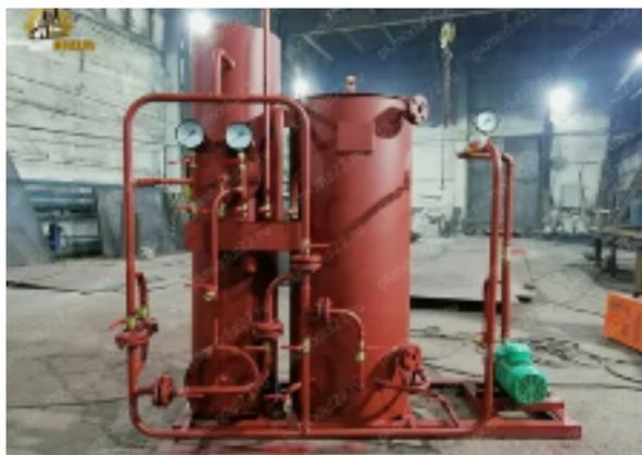
Установка водоподготовительная ВПУ-1, предназначена для умягчения питательной воды из артезианских скважин и водопроводной сети и используется для котельных агрегатов и других объектов, где требуется умягчённая вода.
