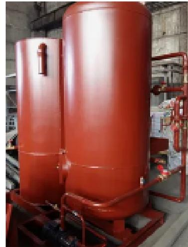
Основными элементами установки ВПУ-3,0 являются: противоточный ионитный фильтр, бак приготовления раствора соли, агрегат электронасосный, трубопроводы и арматура. Оборудование установки смонтировано на раме.
