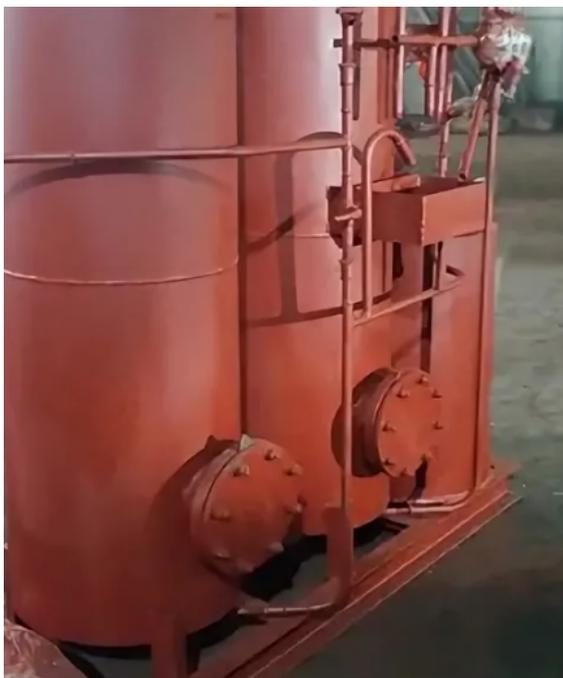
Бак-вытеснитель БНВ-1,6 крепкой серной кислоты предназначен для подачи серной кислоты в мерники и используется на водоподготовительных установках электростанций, промышленных и отопительных котельных.
