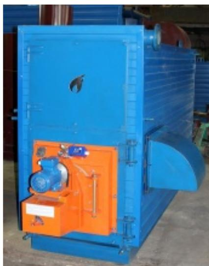
Водогрейный котёл **КВа-0,8** в качестве топлива может использовать сжиженный и природный газ, нефть, мазут или дизтопливо. В зависимости от вида топлива, котёл комплектуется соответствующим горелочным устройством. Горелка монтируется с фронта на специальный лаз. Монтаж-демонтаж горелочного устройства прост и не вызывает затруднений при обслуживании котла.
