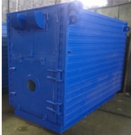
Водогрейный котёл **КВа-1,0** в качестве топлива может использовать сжиженный и природный газ, нефть, мазут или дизтопливо. В зависимости от вида топлива, котёл комплектуется соответствующим горелочным устройством. Горелка монтируется с фронта на специальный лаз. Монтаж-демонтаж горелочного устройства прост и не вызывает затруднений при обслуживании котла.
