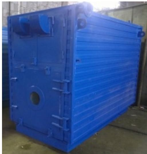
Водогрейный котёл **КВа-1,0** в качестве топлива может использовать сжиженный и природный газ, нефть, мазут или дизтопливо. В зависимости от вида топлива, котёл комплектуется соответствующим горелочным устройством. Горелка монтируется с фронта на специальный лаз. Монтаж-демонтаж горелочного устройства прост и не вызывает затруднений при обслуживания котла.
