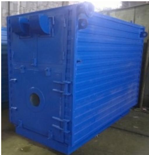
Водогрейный котёл КВа-1,16 в качестве топлива может использовать сжиженный и природный газ, нефть, мазут или дизтопливо. В зависимости от вида топлива, котёл комплектуется соответствующим горелочным устройством. Горелка монтируется с фронта на специальный лаз. Монтаж-демонтаж горелочного устройства прост и не вызывает затруднений при обслуживании котла.
