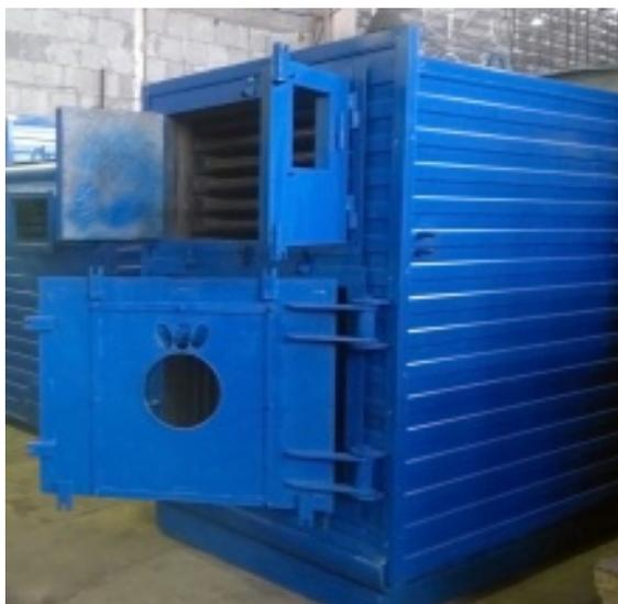
Водогрейный котёл **КВа-1,45** в качестве топлива может использовать сжиженный и природный газ, нефть, мазут или дизтопливо. В зависимости от вида топлива, котёл комплектуется соответствующим горелочным устройством. Горелка монтируется с фронта на специальный лаз. Монтаж-демонтаж горелочного устройства прост и не вызывает затруднений при обслуживании котла.
