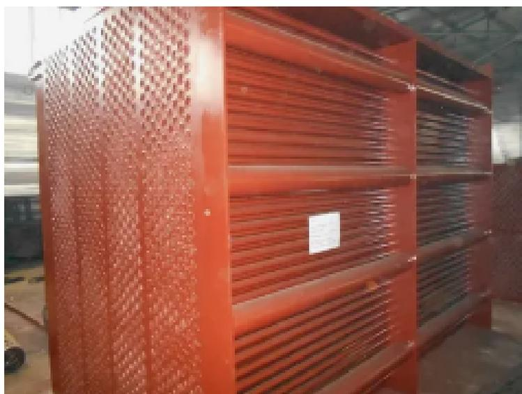
Стальной трубчатый воздухоподогреватель ВП-О-228 предназначен для комплектации котлов КЕ, работающих на высоковлажных топливах (фрезерном торфе, древесных отходах и бурых углях). Воздухоподогреватели устанавливаются в качестве хвостовой поверхности нагрева котельного агрегата.
