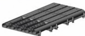
Водоохлаждаемое колосниковое пальто (колосники 280x65 расположены на водоохлаждаемых трубах)
